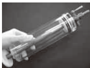
排圧ポンプ はいあつ ④
